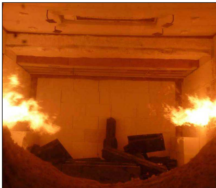
44. min zkoušky - uvolnění vzátěží na všech prvcích - konec pozorování
